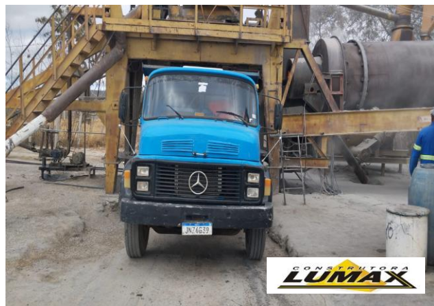
FOTO 03: Usinagem de CBUQ
