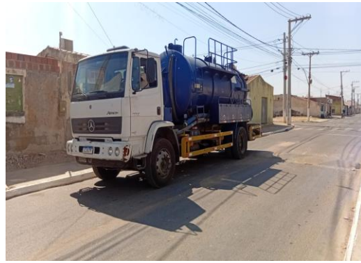
AV CRISTALINA - SERVIÇO DE SEWERJET
