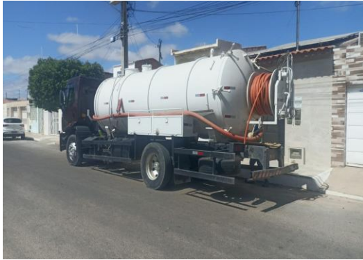
RUA BELA VISTA - DESOBSTRUÇÃO COM SEWER JET
